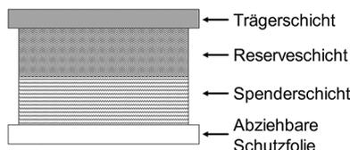
Abbildung 1: Aufbau des Fentanyl TTS vom Matrix-Typ
